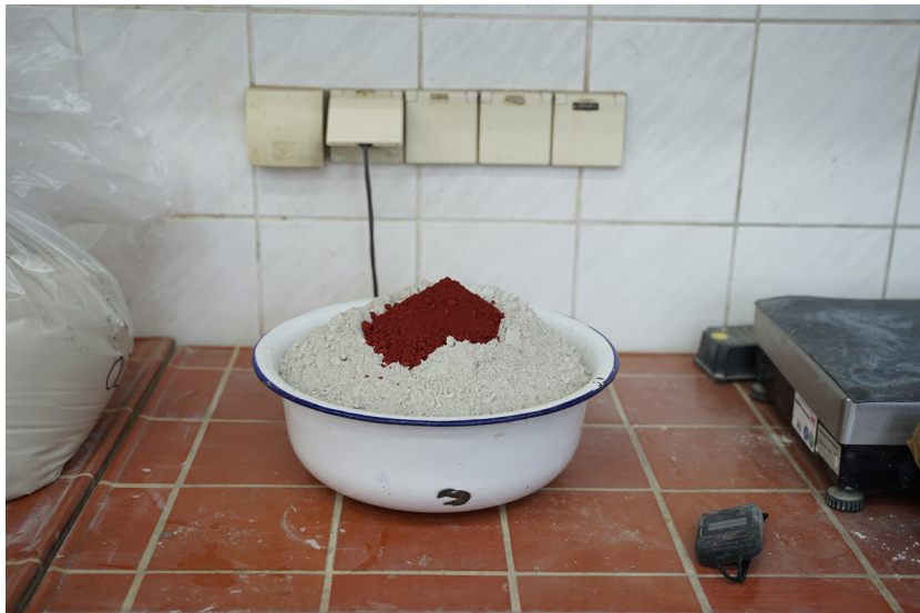
48 Mischung gefärbte Betonfüße
