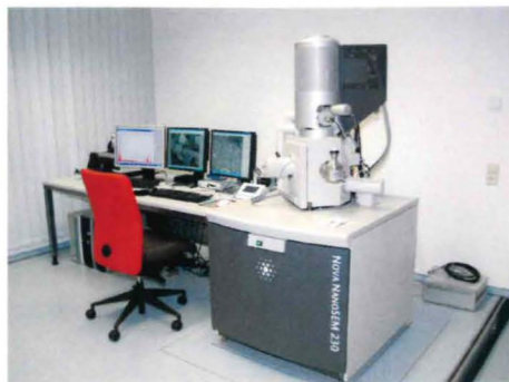
Abb. 24: Das Nova NanoSem – ein modernes Raster-elektronenmikroskop mit Cryo-Präparationseinheit zur Charakterisierung von Baustoffen. FIB 2009.
