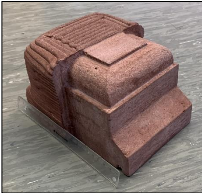
Abb.1: Durch 3D-Extrusion hergestellter Geopolymer-Kunststein halbseitig vor und nach der steinmetzmäßigen Nachbearbeitung
