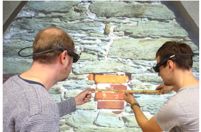
Abb.: Hochauflösende 3D Scans von Gebäuden ermöglichen eine ortsunabhängige Schadenskartierung und Sanierungsplanung in kollaborativer virtueller Realität (Abb. Virtual Reality and Visualization Research Group)
