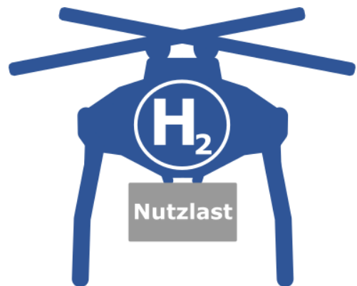
Hubschrauberdrohne mit Flettner-Doppelrotor (Abb. erstellt durch Professur Energiesysteme)
